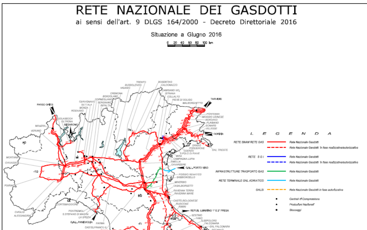
Figura n. 3.11 - Rete dei gasdotti dell'Italia settentrionale (fonte Sito internet società SNAM)
