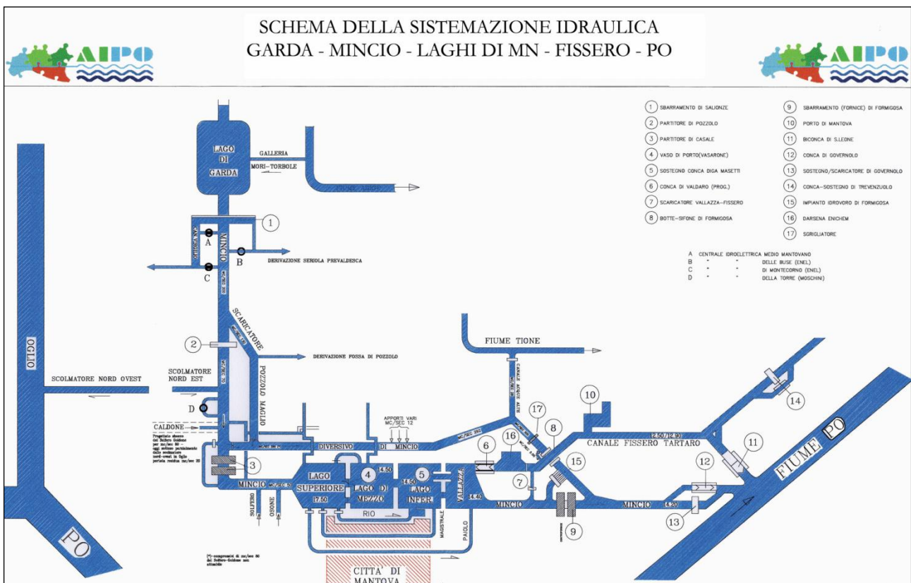
Figura 3.7 - Rappresentazione schematica dell'attuale assetto idraulico del fiume Mincio
