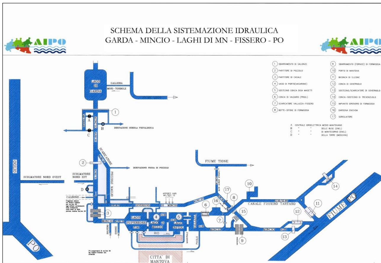
Figura 8.8 - schema della sistemazione idraulica del sistema Garda - Mincio - Laghi di Mantova - Fissero - Po
